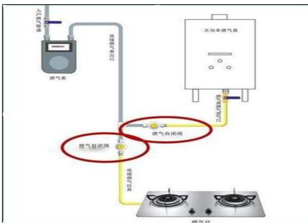
燃气自闭阀安装示意图
